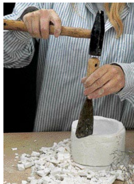
▲ 7. Seejärel pannakse klaas sulatusvormi. Vaadake klaasitükkide paigutust. Ümaramad ja keskmise suurusega tükid asetatakse vormi sisse, pikad tükid pannakse vormi püsti, keskosaga poole kaldu.
