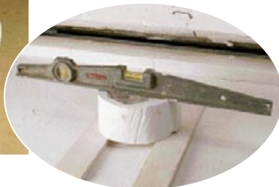
▼ 8. Sulatusvorm pannakse ahjus pikisuunaleste tugele, et vältida kontakti ahju põhjaga. Loodiga kontrollitakse vormi horisontaalsust (eemaldades vajadusel ajutiselt mõned klaasitükid, nagu siin).
